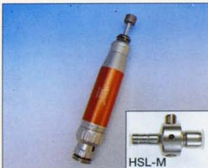
La rotativa neumática DIPROFIL, HPL está movida por el mismo tipo de motor de aire que la limadora, pero con un sentido de la rotación de derecha-izquierda.
