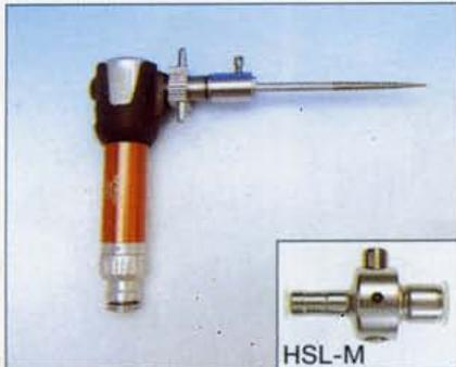
Las Limadoras neumáticas DIPROFIL, FPD, FPL están basadas en la amoladora DIPROFIL movida por un motor de aire de pistones de 18 cilindros radial especialmente desarrollado y con un regulador de velocidad integrado.
